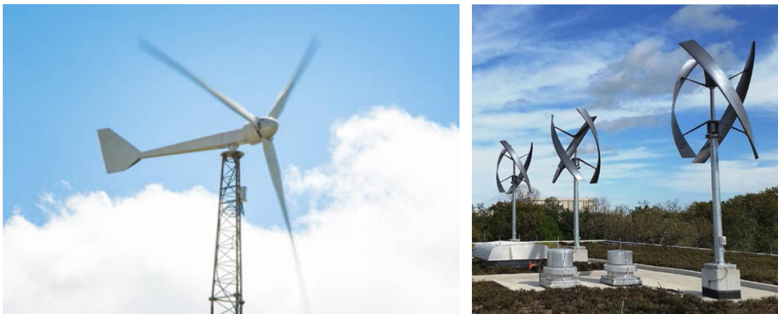
图 41：典型水平轴小型风力涡轮机和垂直轴风力涡轮机
